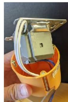
Durch die geschickte Installation kann der SMI Anschluss jederzeit mit einer Netzwerkdose mit mit RJ45 Anschlüssen oder WLAN ausgetauscht werden.
